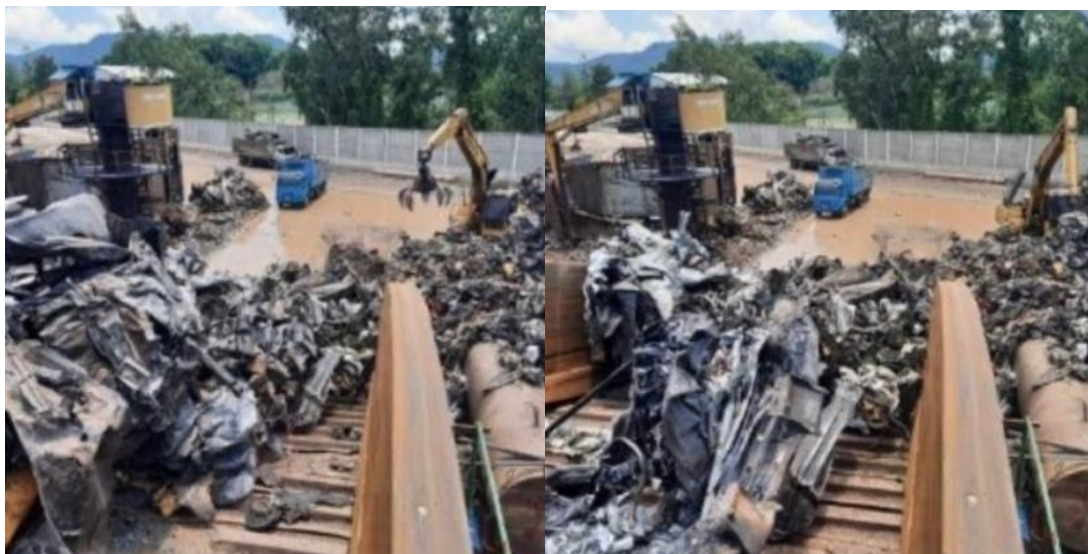
รูปที่ 4.5 ทำความสะอาดวัตถุดิบหลังจากทำการ Pre- shredder ก่อนลำเลียงไปยัง เครื่อง shedder ที่มา บริษัท ชันเทค เมทัลส์ จำกัด
