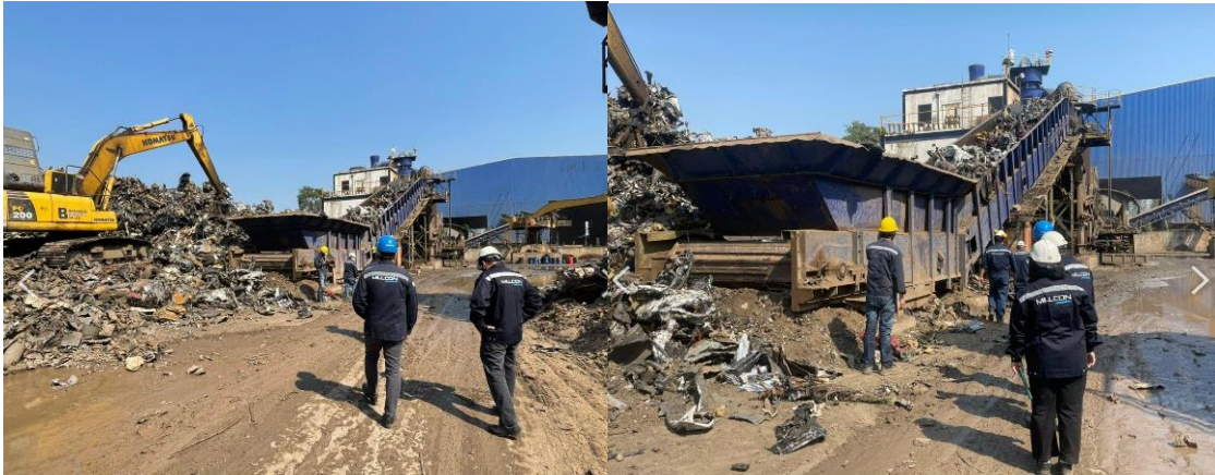
รูปที่ 4.6 ลำเลียงซากรถยนต์ฉีกบดผ่านสายพาน (Conveyer) ไปยังในส่วนเครื่อง Shredder ที่มา บริษัท ชันเทค เมทัลส์ จำกัด
